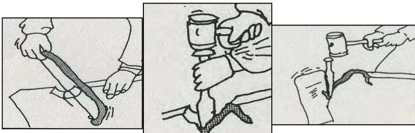
**La fente** : Le fendeur divise l'ardoise en détachant les feuillets suivant les plans de schistosité, à l'aide d'un **maillet** et d'un **ciseau**.
